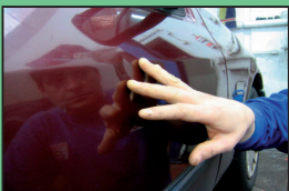
Die Hebeltechnik an leicht zugänglichen Bauteilen. Überhöhungen werden vorsichtig zurückmodelliert
