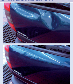
Die Hebeltechnik an leicht zugänglichen Bauteilen. Überhöhungen werden vorsichtig zurückmodelliert
