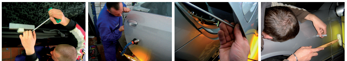
Die Hebeltechnik an leicht zugänglichen Bauteilen. Überhöhungen werden vorsichtig zurückmodelliert
