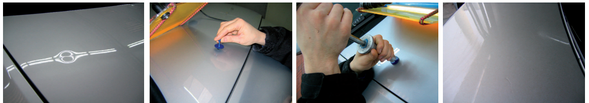
Beispiel einer Dellenbeseitigung mit der Klebe-Zieh-Technik an einem schwer zugänglichem Bauteil
