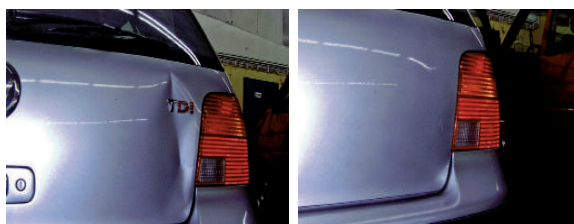
Die Hebeltechnik an leicht zugänglichen Bauteilen. Überhöhungen werden vorsichtig zurückmodelliert
